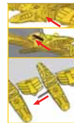
Сменные пластины для защиты дна ковша
