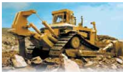
Стойка-рыхлитель, изготовленная из целого листа металла
